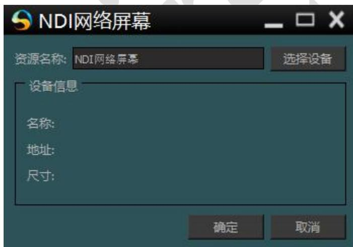
点击选择设备会出现下图，之后根据被采集端电脑的 ip 添加相应的 NDI 设备，点击确定就可将添加的 NDI 设备当做一个素材来使用了。
